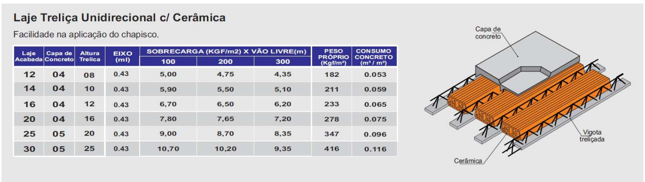
Figura 38 - Laje treliçada unidirecional com blocos cerâmicos
