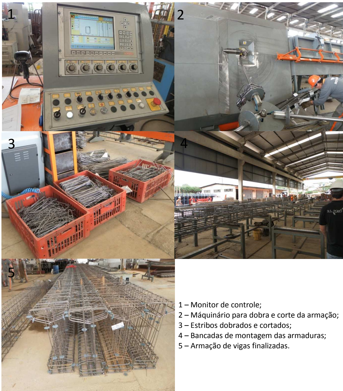
Figura 19 – Processo de montagem automatizado de armação para vigas e pilares
