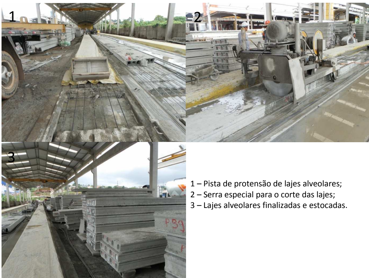
Figura 21 – Processo de fabricação de lajes alveolares
