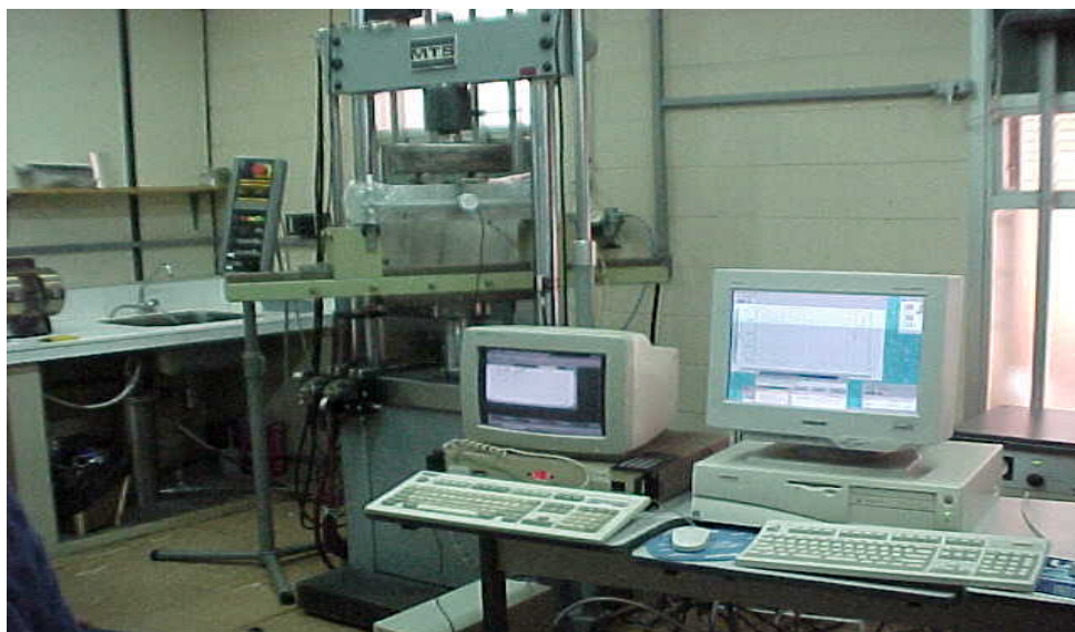
Figura 56 - Viga sendo submetida ao teste “Four Point Bending”
