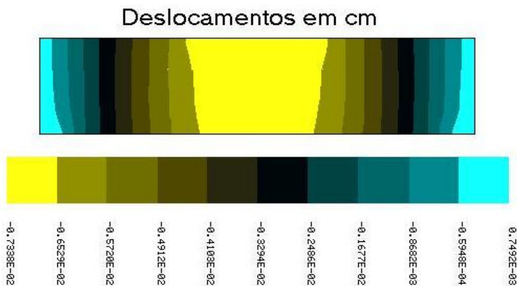
Figura 65 – Deslocamentos verticais - Modelo 2D Elástico (FRANC2D)
