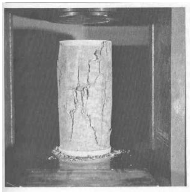
Figura 109 – Quadro final de fissuração para ensaio de compressão axial (Fonte: MEHTA(1985))
