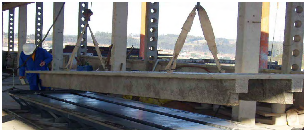
Figura 1.2 - Laje pré-moldada em duplo T: exemplo típico de estrutura sujeita descontinuidade geométrica
