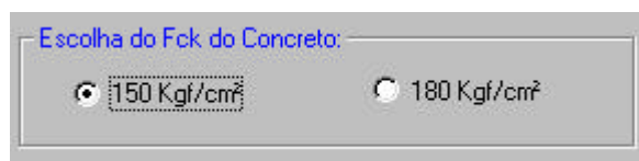
Figura 27 – Escolhendo a resistência do concreto
